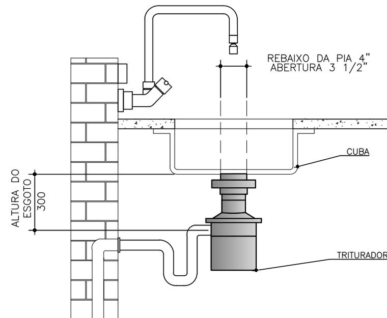
O TRITURADOR é um equipamento simples e de fácil instalação, você necessitará de uma cuba com abertura de 90 mm de diâmetro (4,5\"), e dois pontos de energia, conforme ilustração acima:
